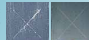
当社耐塩水噴霧試験用シンクリッチペイント 水性ジンキー8000HB(新)
