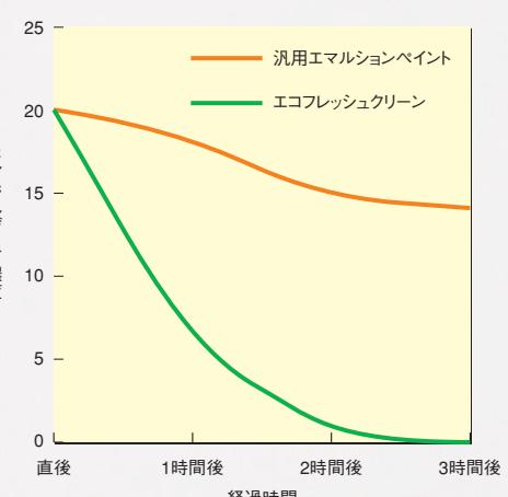
図-2 ホルムアルデヒド吸着試験結果
